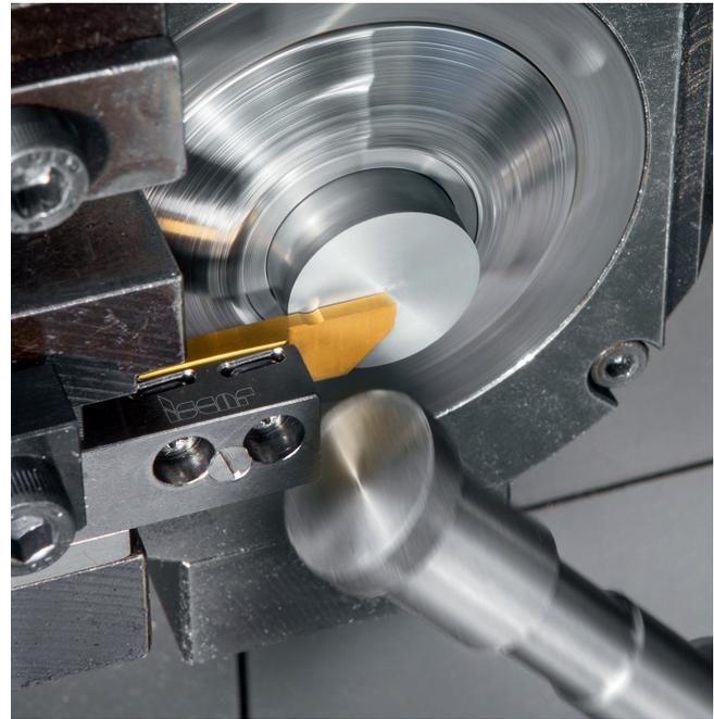
3 'Swisscut XL' – das Werkzeug mit extra langen Wendeschneidplatten von Iscar zielt auf eine größere Schnitttiefe als üblich beim Ab- und Einstechen sowie beim Stechdrehen © Iscar
