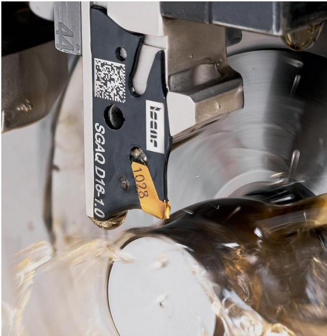
2 Der Präzisionswerkzeug-Spezialist hat außerdem das modulare Abstech- und Einstechwerkzeug 'Neogrip' speziell für Langdrehmaschinen entwickelt © Iscar
