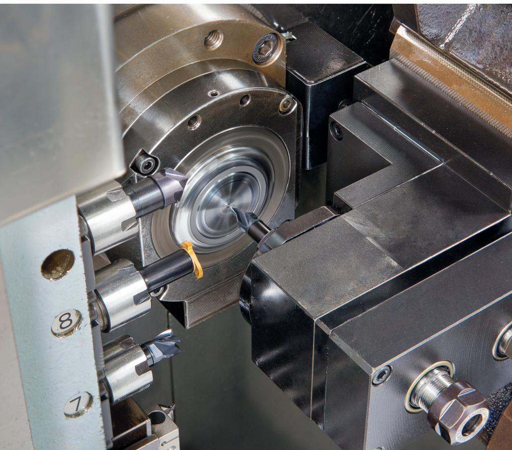
1 Das modulare Wechselkopf-Frässystem 'Multimaster' von Iscar bietet für jede Anwendung auf Langdrehmaschinen eine passende Lösung. Durch das Wechseln der Fräsköpfe in der Maschine entfallen unproduktive Nebenzeiten © Iscar
